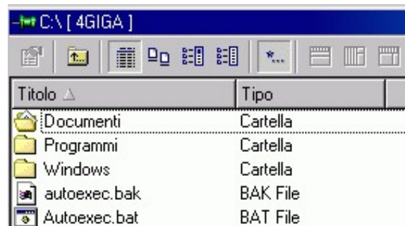
Figura 15–7. I pulsanti per regolare la visualizzazione nell'Explorer di StarOffice (sono il terzo e il settimo da sinistra, mostrati "premuti").
